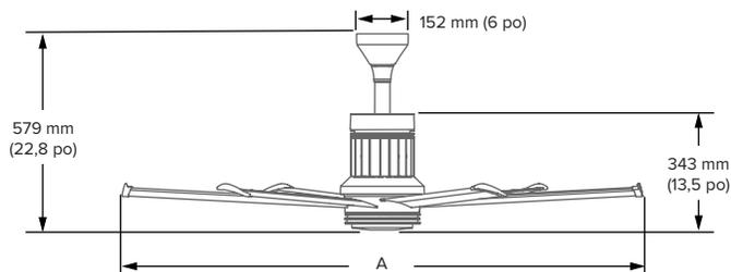
Avec tige de suspension de 152 mm (6 po) et kit d'éclairage<sup>5</sup>
